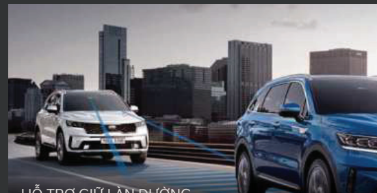
HỖ TRỢ GIỮ LÀN ĐƯỜNG (Lane Following Assist - LFA) Hệ thống hỗ trợ giữ làn đường có thể nhận ra các vạch kẻ đường và hỗ trợ đánh lái để giữ xe luôn đi ở trung tâm làn đường.
